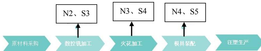
图3 注塑模具生产流程及排污节点图
